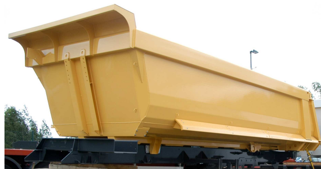
Abbildung 2: MKI-Mulde mit Hilfsrahmen
