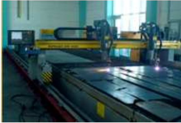
Abbildung 5: Ausbrennen der Einzelteile im Zuschnitt [JUE09]
