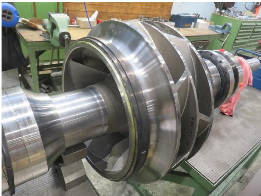
Abbildung 1 Doppelflutiges Laufrad Pumpentyp ZMK
