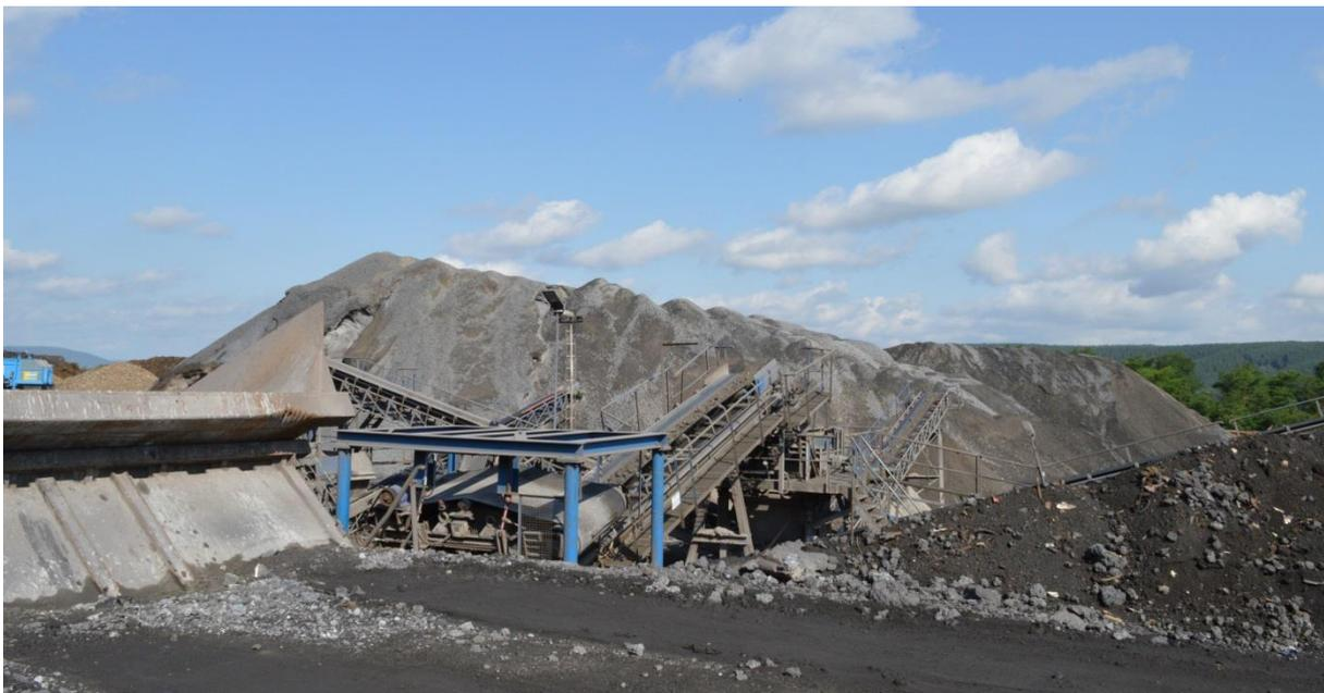
Abbildung 10 Weiterverarbeitung der Schlacke auf dem Gelände der RGA Unterwellenborn, Foto: Melissa Wolfram
