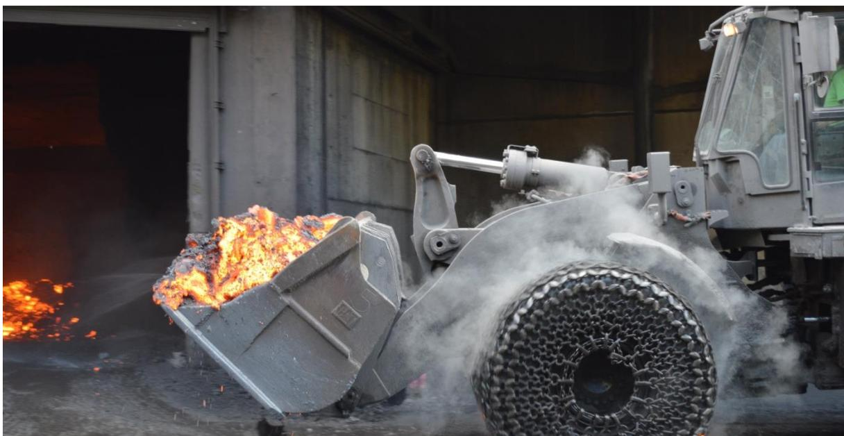
Abbildung 7 Radlader mit frischer Schlacke aus dem Clean-Pit, Foto: Melissa Wolfram
