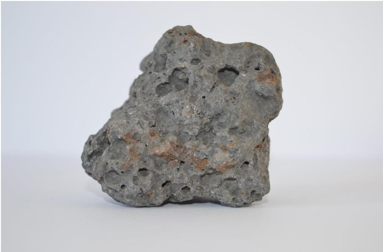
Abbildung 15 Elektroofenschlacke aus Unterwellenborn, Foto: Melissa Wolfram
