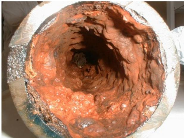
**Abbildung 13: Rohrleitung mit starker Inkrustation**
