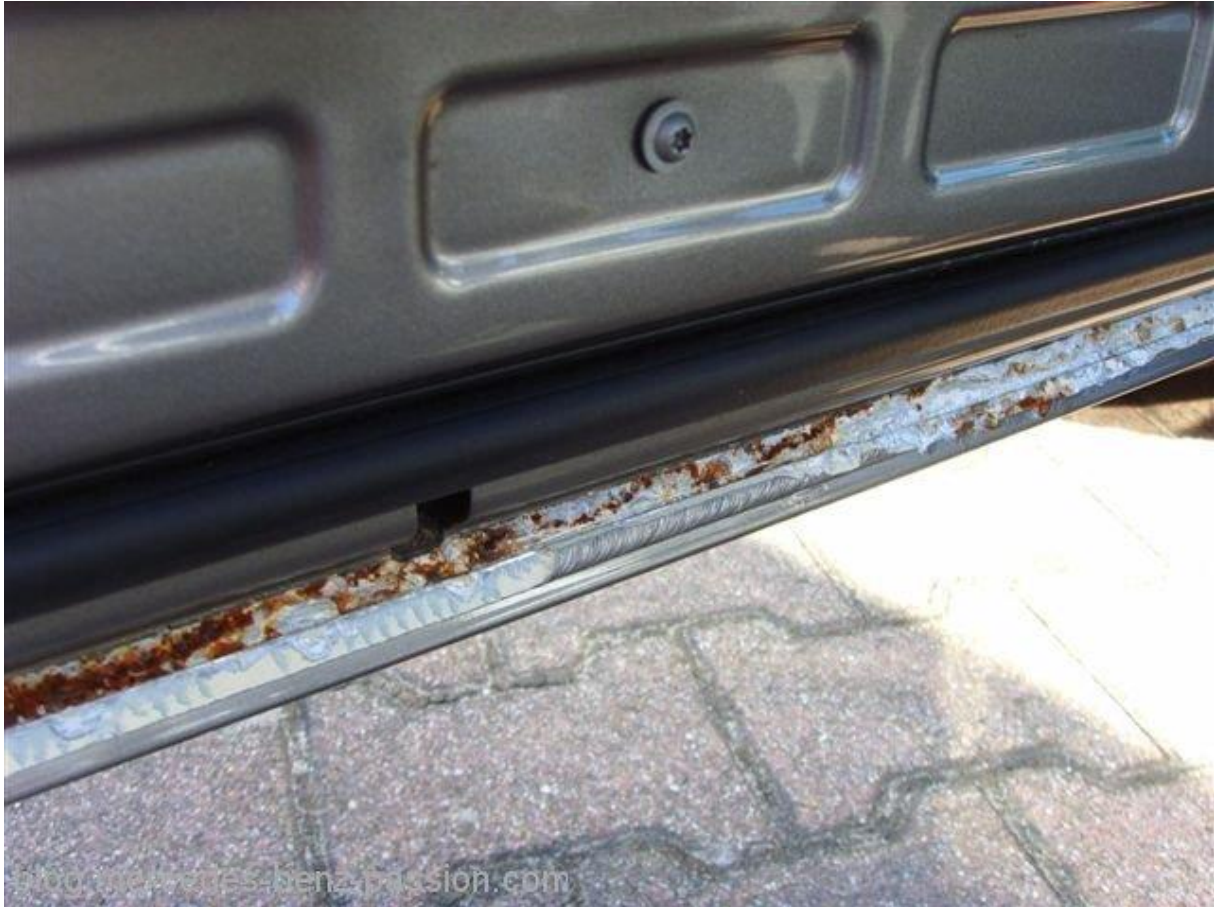
Abbildung 11 Verrosteter Türfalz Mercedes B-Klasse Baureihe W245
