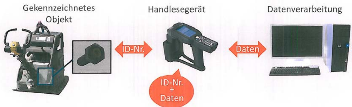
Abbildung 15 Ablauf Aus- und Rückgabe mit RFID oder Barcode (Bock & Markert - Erfassen mit System, 2011)
