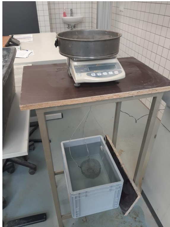
Abbildung 16 Waage mit angehängtem Drahtkorb im wasserdichten Behälter (eigene Aufnahme)
