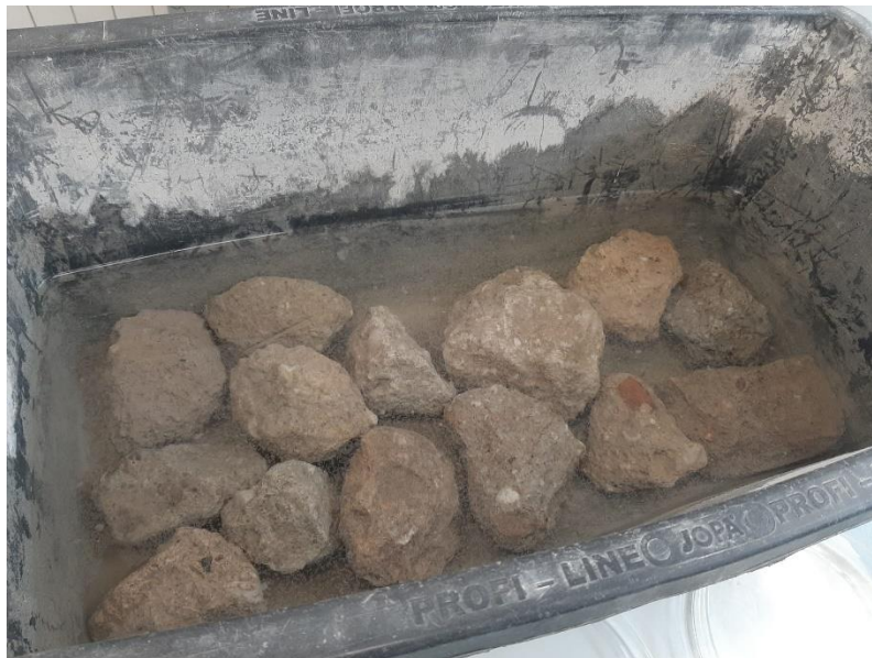
Abbildung 17 RC-Gesteinskörnung im Wasserbad (eigene Aufnahme)
