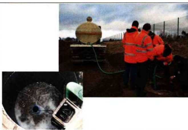
Durchführung des Sickerversuchs 782 (12/2011)
