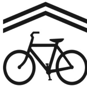
**Abbildung 10** Piktogramm zur Signalisierung der Fahrstreifenmitbenutzung durch den Radverkehr
