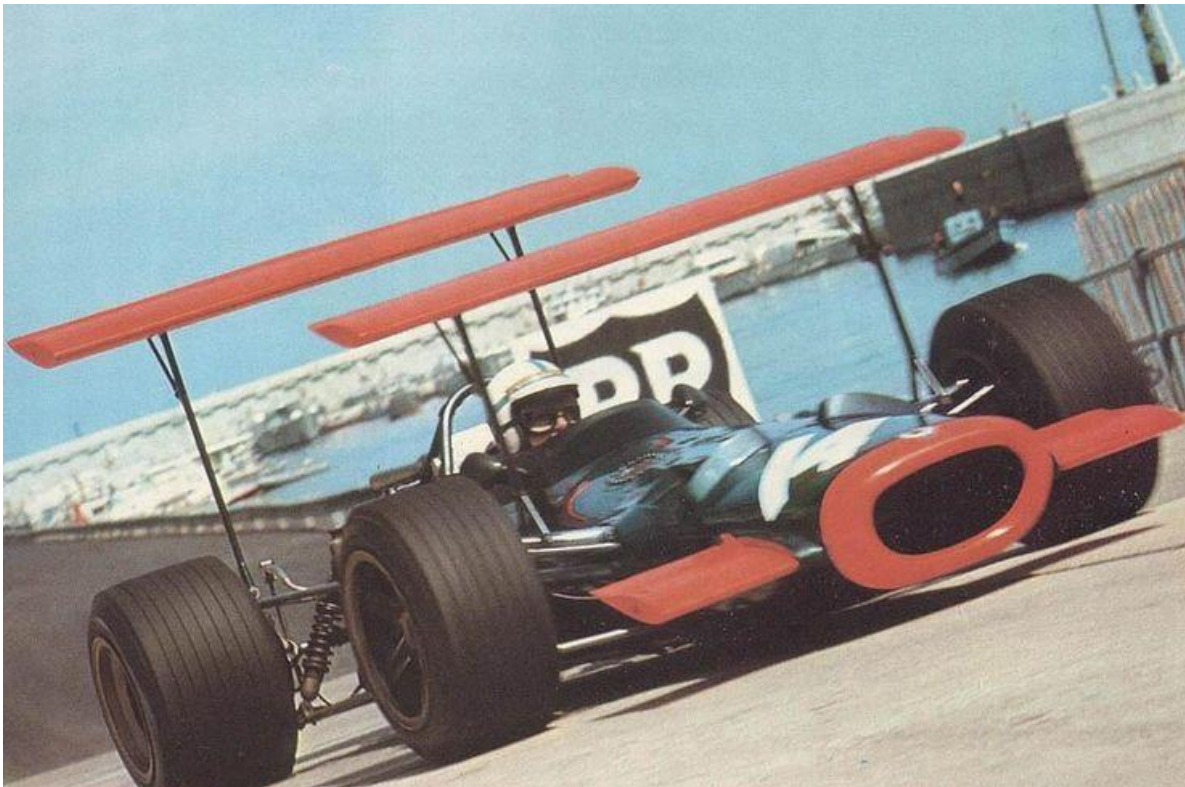
Abbildung 5 Ein Beispiel aerodynamischer Prototypen: der BRM P 138 mit zwei Tragflächen
