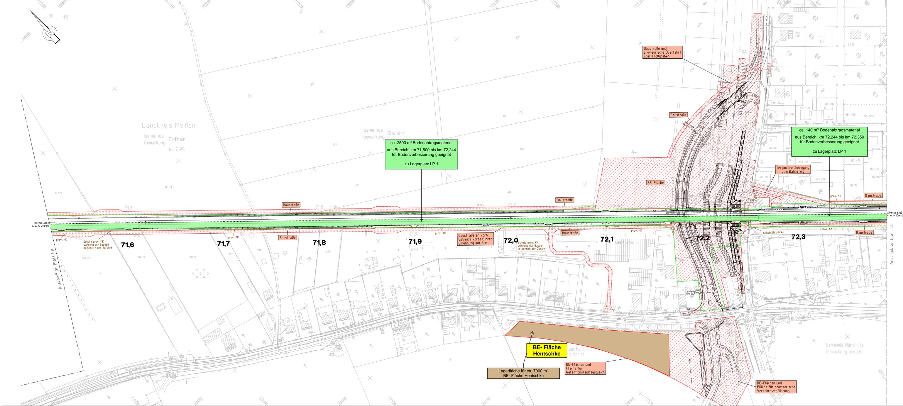
ca. 2500 m<sup>3</sup> Bodenabtragsmaterial aus Bereich: km 71,500 bis km 72,244 für Bodenverbesserung geeignet zu Lagerplatz LP 1
