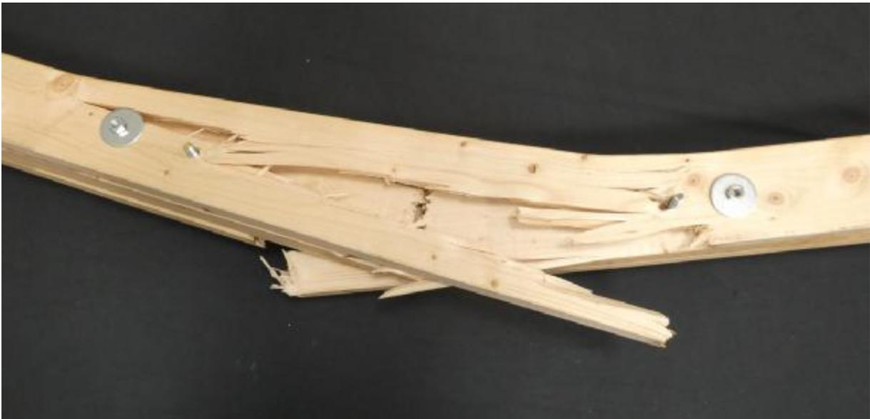
**Abbildung 22** Bruchbild des Versuchs 5.1
