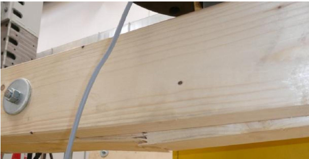
**Abbildung 23** Bruchbild an Unterseite des Versuchskörpers 5.2
