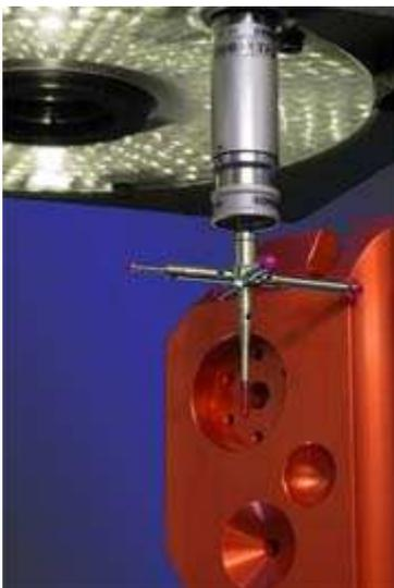
**Abb. 8:** Taktile arbeitender 3D-Messtaster
