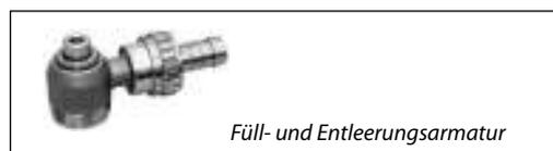
Zur Entleerung wird zunächst die Abdeckkappe von der Rücklaufverschraubung abgeschraubt und die Rücklaufverschraubung abgesperrt. Nach Aufschrauben der Entleerungsarmatur kann diese durch Linksdrehung des Vierkants geöffnet werden. Die mitgelieferte Schlauchtülle ist anwendergerecht frei nach allen Seiten drehbar. Die Entleerungsarmatur ist unvernickelt.
